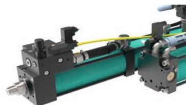
O **amortecedor de impacto de corte ZSD** amortece o pistão de trabalho quando a força contrária cessa, por exemplo, durante aplicações de punção. Por ser um amortecimento puramente mecânico, também pode ser usado, com limitações, como amortecimento de curso.
