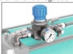
O **acionador externo do curso de força ZKHZ** realiza a conexão da válvula de curso de força por meio de um atuador de válvula 3/2 vias acionado eletricamente. Isso é recomendado para a conexão do curso de força dependente do deslocamento ou para interrupções no curso rápido de aproximação, de acordo com a aplicação. O ZKHZ também é ideal ao usar o Cilindro Hidropneumático TOX® com a haste do pistão apontando para cima e grande peso da ferramenta.
