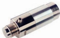
Todos os Cilindros Hidropneumáticos TOX® dos tipos linha-Q e linha-X até o tamanho 030 estão equipados com um cilindro especial e um disco magnético no pistão de trabalho. A **deteção de curso para avanço e retorno ZHU** determina sua posição através de um sensor. Isso permite detectar ponto morto superior e inferior, assim como demais detecções opcionais relevantes para sua aplicação.
