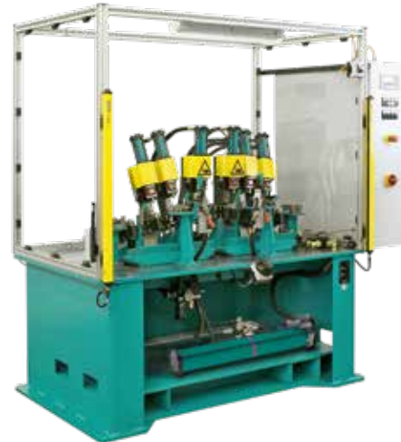
X-KT-System eingebaut in Sondermaschine
